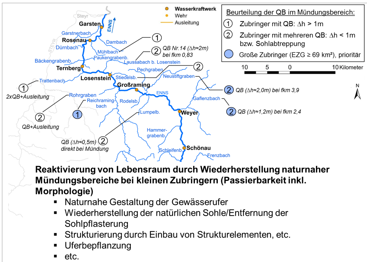
Abb. 7.3: Ökologisches Maßnahmenkonzept für die kleinen Zubringer innerhalb der EKW-Staubereiche; QB = Querbauwerk
